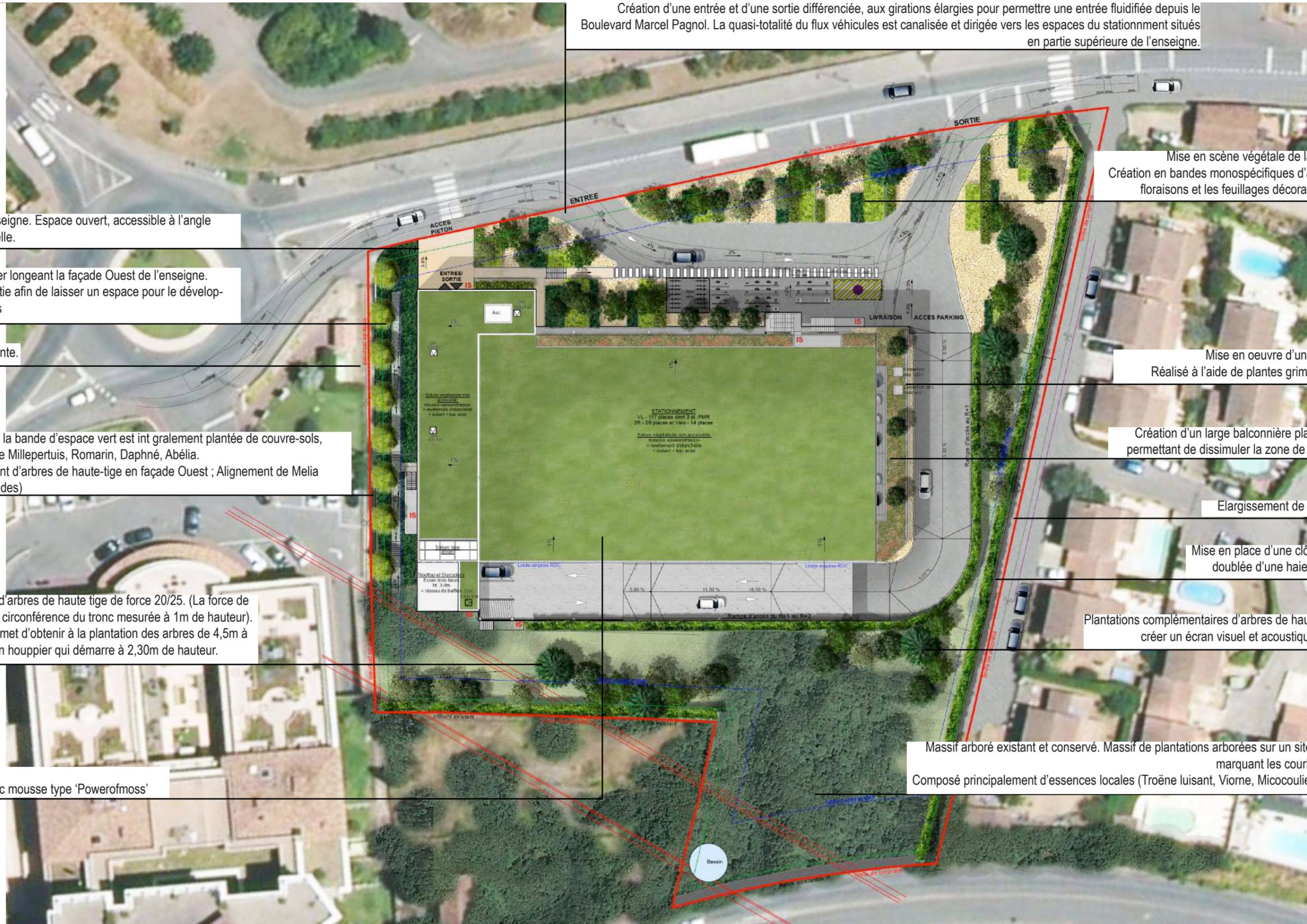
Création d'une entrée et d'une sortie différenciée, aux girations élargies pour permettre une entrée fluidifiée depuis le Boulevard Marcel Pagnol. La quasi-totalité du flux véhicules est canalisée et dirigée vers les espaces du stationnement situés en partie supérieure de l'enseigne.
