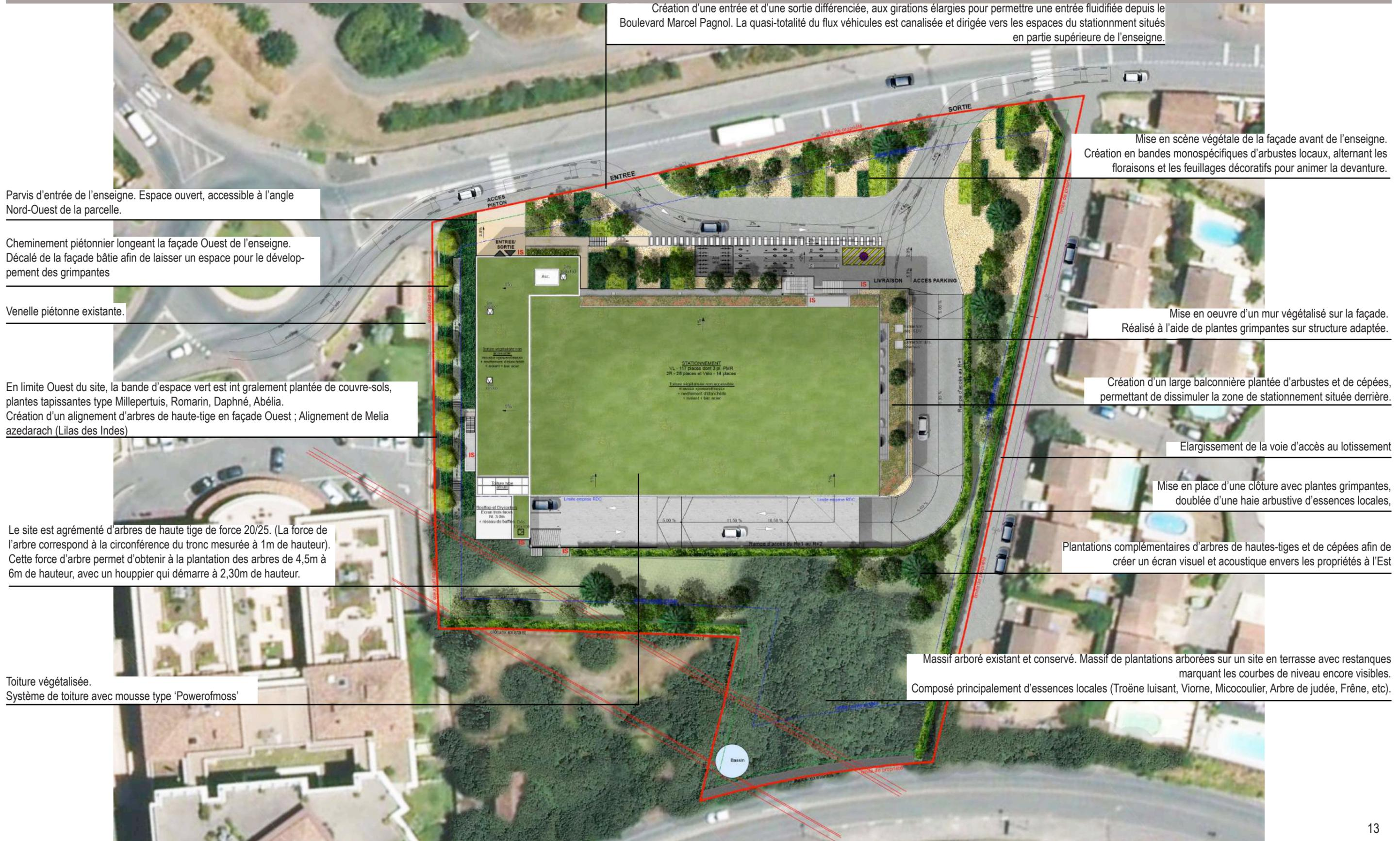
Création d'une entrée et d'une sortie différenciée, aux girations élargies pour permettre une entrée fluidifiée depuis le Boulevard Marcel Pagnol. La quasi-totalité du flux véhicules est canalisée et dirigée vers les espaces du stationnement situés en partie supérieure de l'enseigne.
