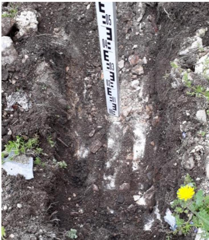
Certains sondages à la pelle mécanique ont néanmoins obtenu des refus nets sur des formations calcaires ou gréseuses (cf photo ci-dessus).
