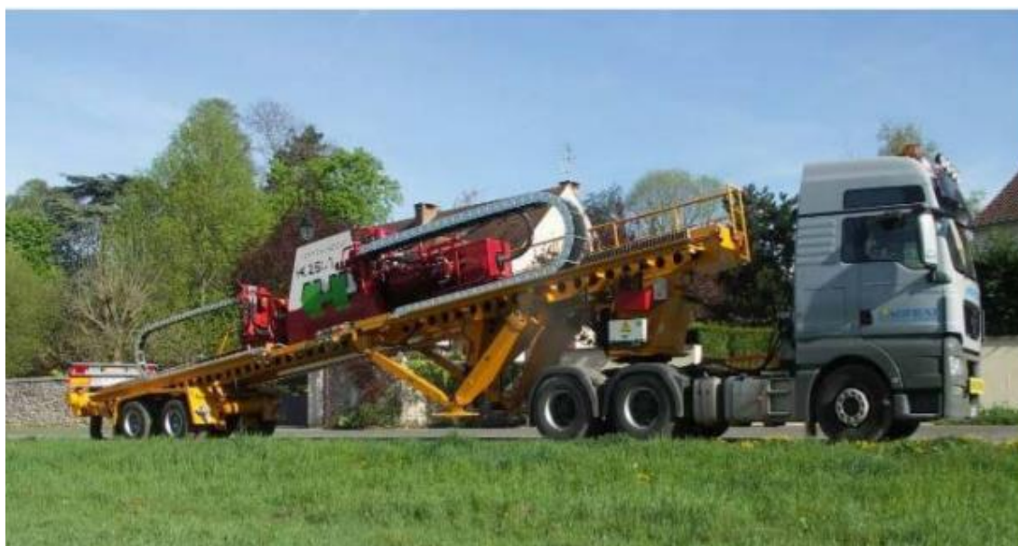
FIGURE 9 : EXEMPLE D'UNITÉ DE FORAGE DIRIGÉ
