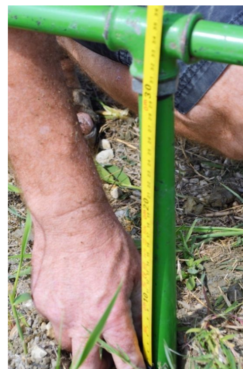
Prélèvements à un 1 m de profondeur niveau de l'aparition de l'eau
