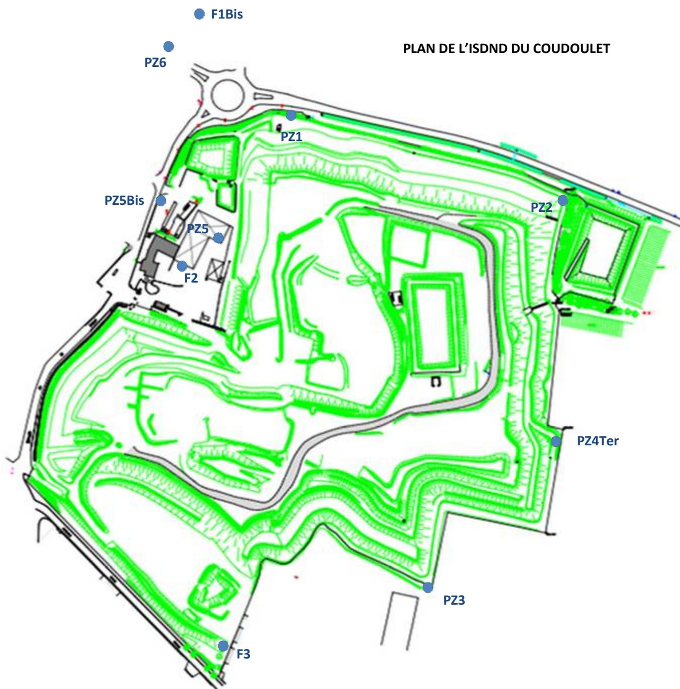
Figure 3 : Localisation du réseau de surveillance sur le plan de masse du site
