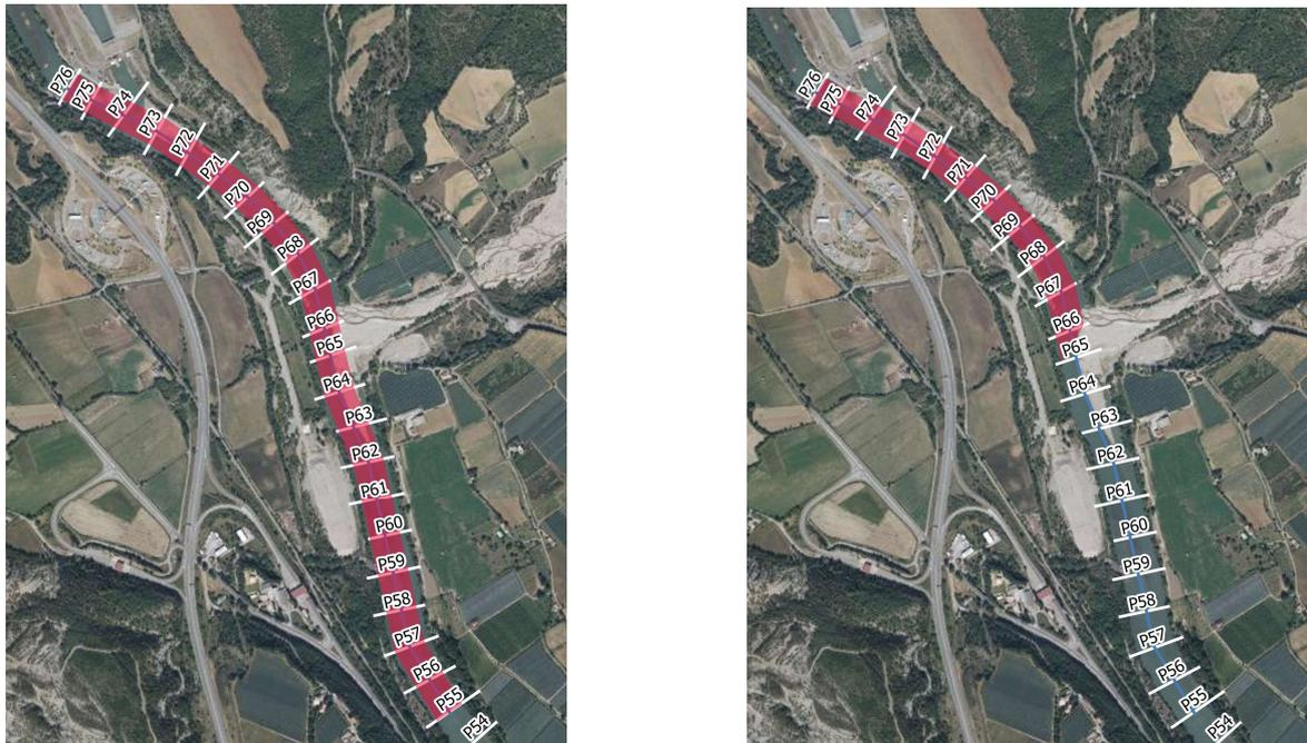
Figure 1. Curage dit optimisé (« fonds cible ») à gauche et curage prévu en 2022 à droite
