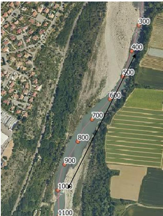
Levé bathymétrique de la mouille amont à réaliser du pk 400 au pk 1000
