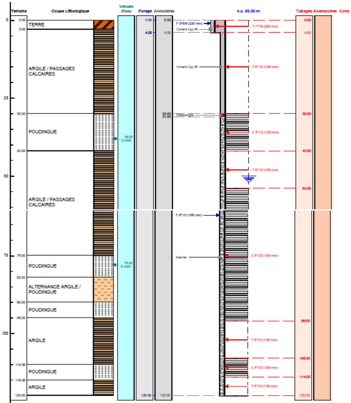
Coupe technique et géologique du forage F1 réalisé en 2022
