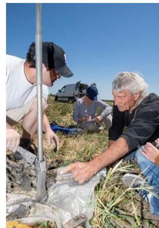
*Figure 33 : carottage à la tarière réalisé en 2020 sur le Cassaire par l'Université de Strasbourg en présence d'Otello Badan (Corinne Rousse)*
