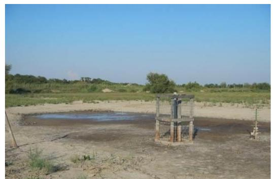
Station automatique de relevé des niveaux d'eau et règle de lecture visuelle sur la mare du Clos des Vaches (L. Debiesse)
