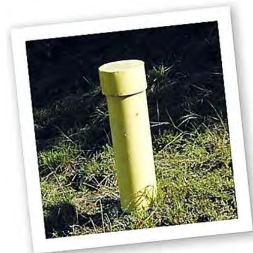
■ Niveau NGF : La hauteur d'eau dans les ouvrages est suivie en référence au niveau NGF (Nivellement Général de la France). Sur l'année 2020 le battement maximal de la nappe, observé entre périodes de basses et hautes eaux, est compris entre 0,25 m à 2,22 mètres.
