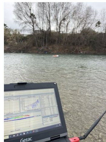
Jaugeage au Drone aquatique sur le Fleuve Var à Nice mi janvier 2025 (Source : DREAL PACA)
