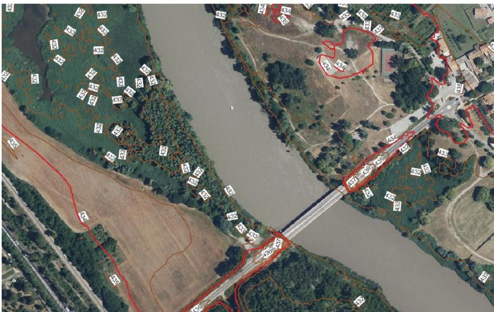
Figure 14 : Niveau d'eau pour une Q100 sur le secteur de Volonne
