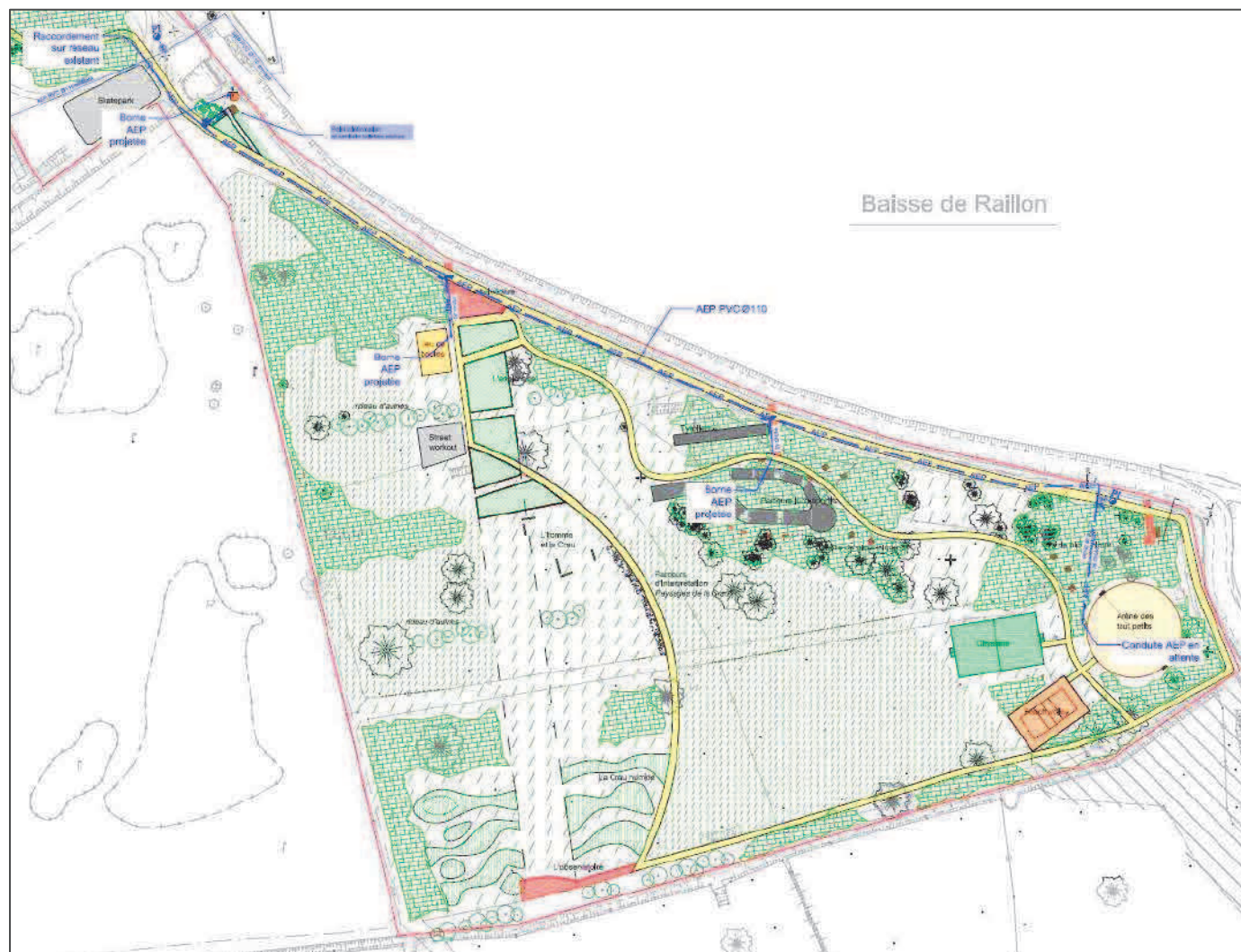
Illustration 5 : Plan des réseaux secs et humides projetés
