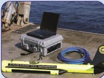
Son faible poids permet à une seule personne une mise en œuvre aisée à partir d'une embarcation légère.
