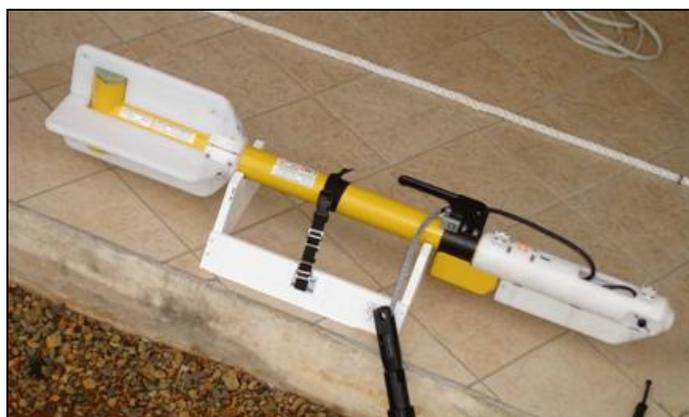
Magnétomètre type G882
