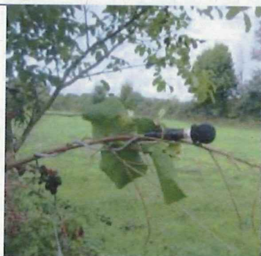
Boîtier et micro du SM 2 BAT permettant d'enregistrer les contacts de chauves souris sur une nuit complète.
