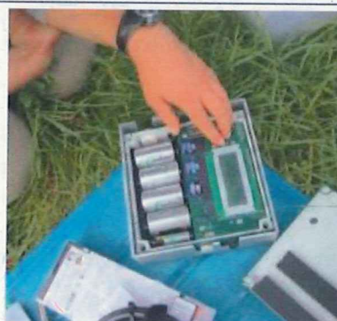
Boîtier et micro du SM 2 BAT permettant d'enregistrer les contacts de chauves souris sur une nuit complète.
