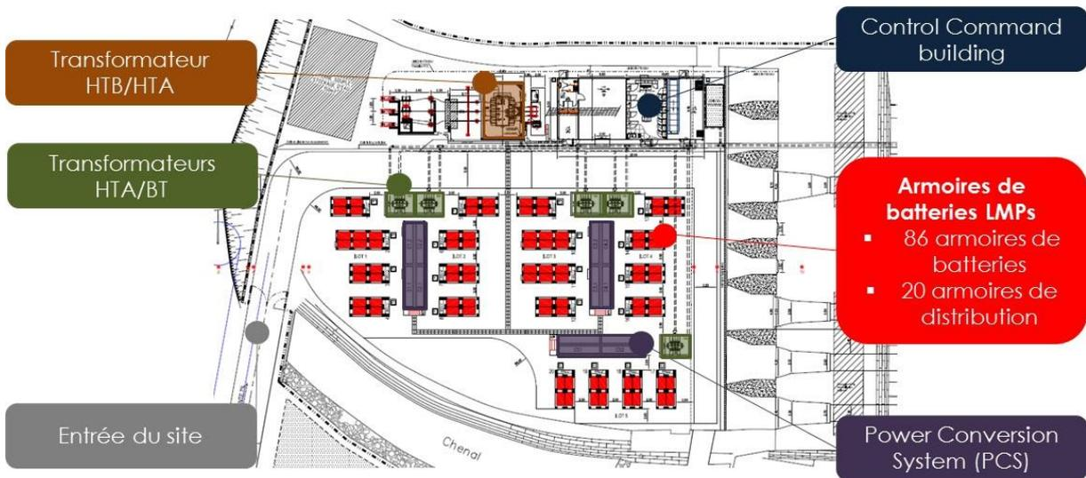
Figure 2- Plan de masse du projet avec ses principaux composants
