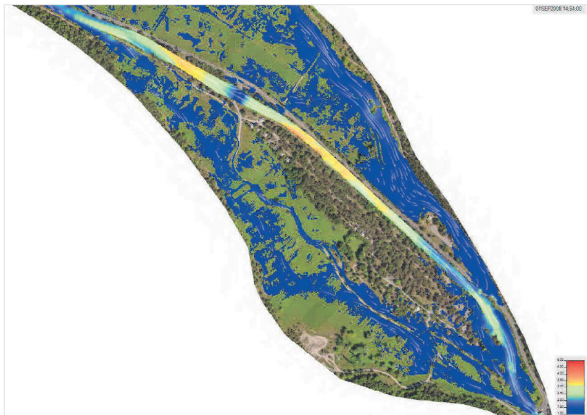
Fig. 57 : vitesses maximales atteintes et lignes de courant – Q50 - situation actuelle
