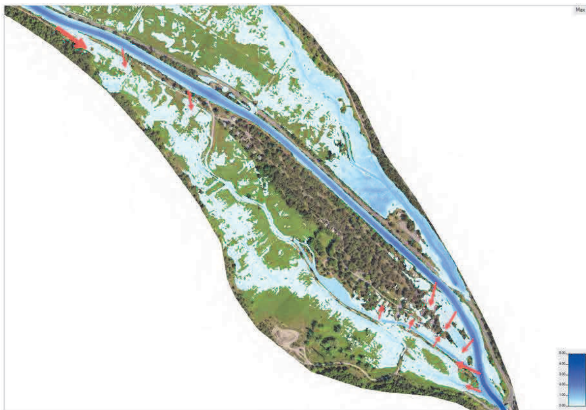
Fig. 55 : Hauteurs maximales pour la crue cinquantennale et localisation des principaux points de débordement en rive droite (flèches rouges) – Q50 - situation actuelle
