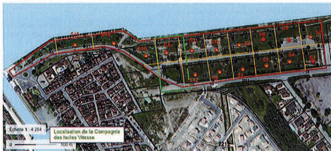
Figure 13- Localisation des sondages réalisés sur la zone d'étude réalisée par ARTELIA en février et avril 2019
