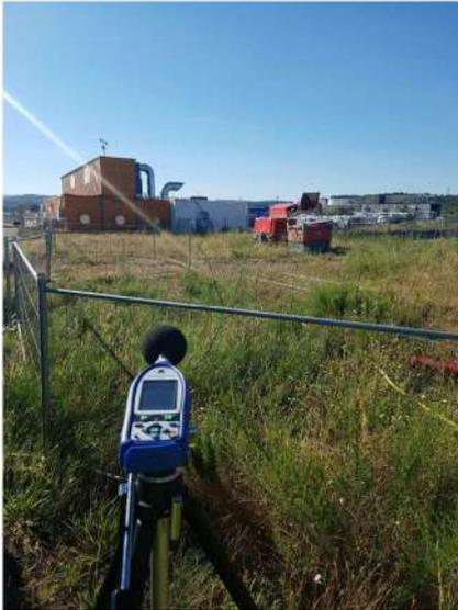
Photo 7 : Mesure de l'opération de désamiantage (LP2 et LP9)
