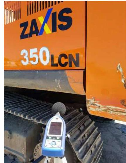
Photo 12 : Mesure des opérations à la pelle (LP19)
