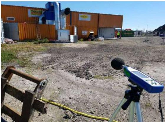
Photo 9 : Mesure de l'opération de désamiantage (LP6 et LP10)
