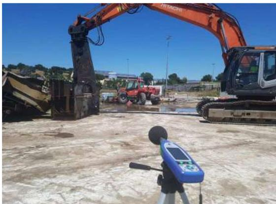
Photo 5 : Mesure de l'opération de découpe à la pelle (LP11)
