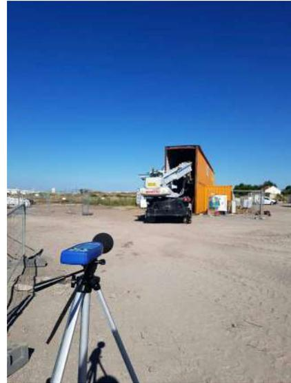
Photo 8 : Mesure de l'opération de désamiantage (LP4)
