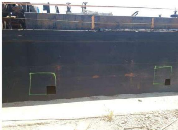
Photo 1 : Marquage pour opération d'oxycoupage à l'extérieur de la coque
