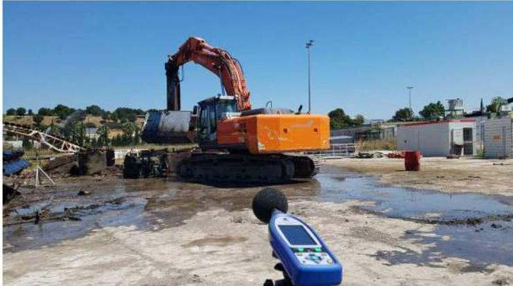
Photo 11 : Mesure des opérations à la pelle (LP18)
