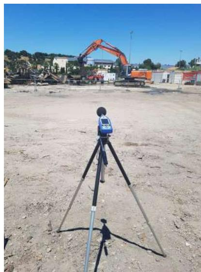
Photo 6 : Mesure de l'opération de découpe à la pelle (LP11)
