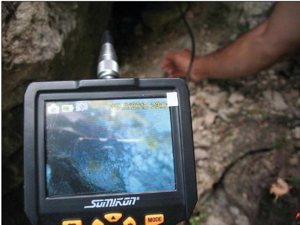
**Utilisation de l'endoscope : vue de l'écran de contrôle, l'embout étant dans une fissure**
