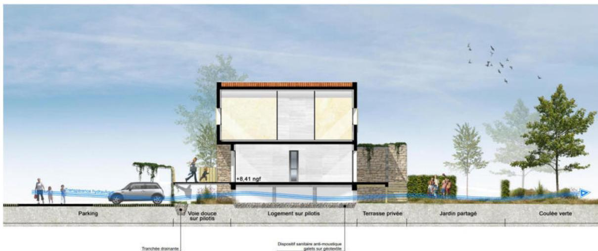
Figure 35. Principe de transparence hydraulique – coupe maison individuelle sur pilotis (source : YK, MAP)
