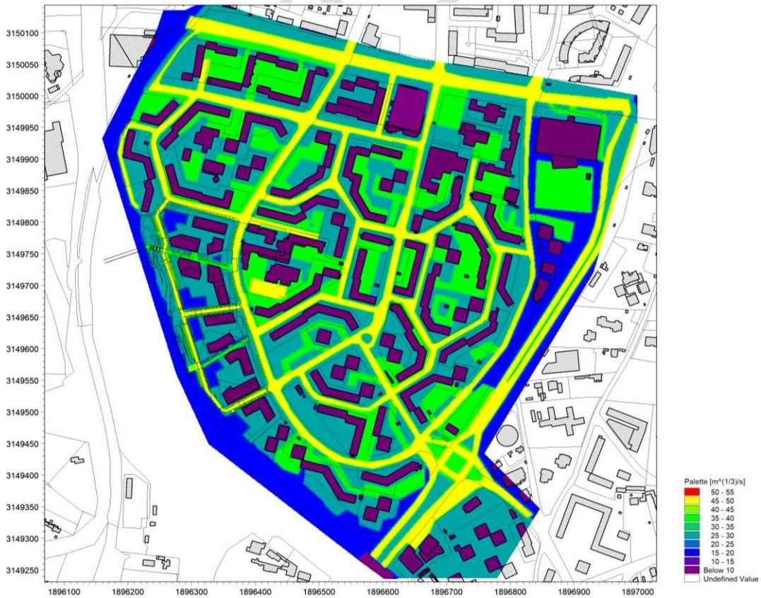
Figure 30 : Modèle de rugosité à l'état projeté
