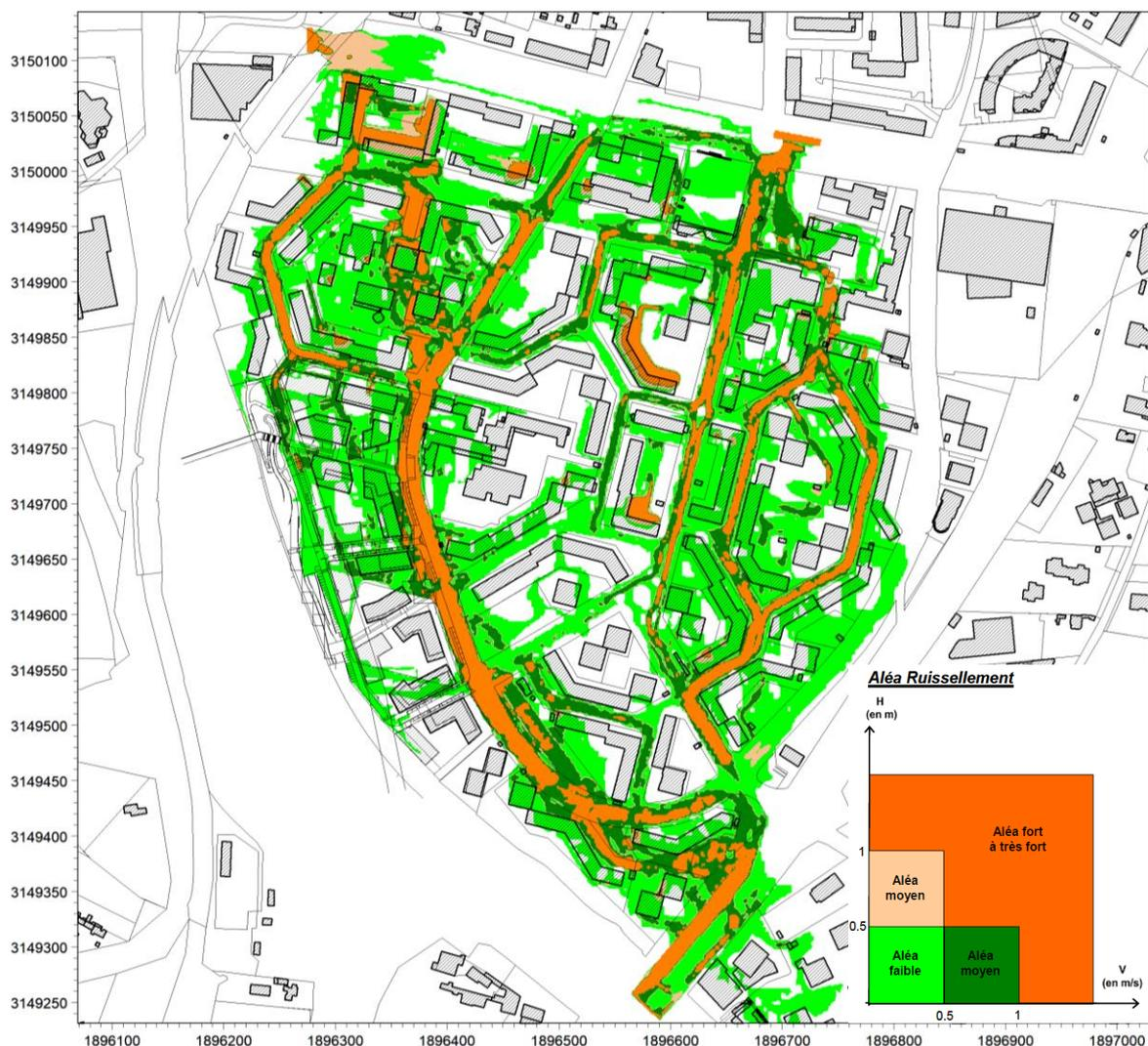
Figure 32 : Cartographies des hauteurs d'eau maximales et des vitesses maximales d'écoulement à l'état projeté
