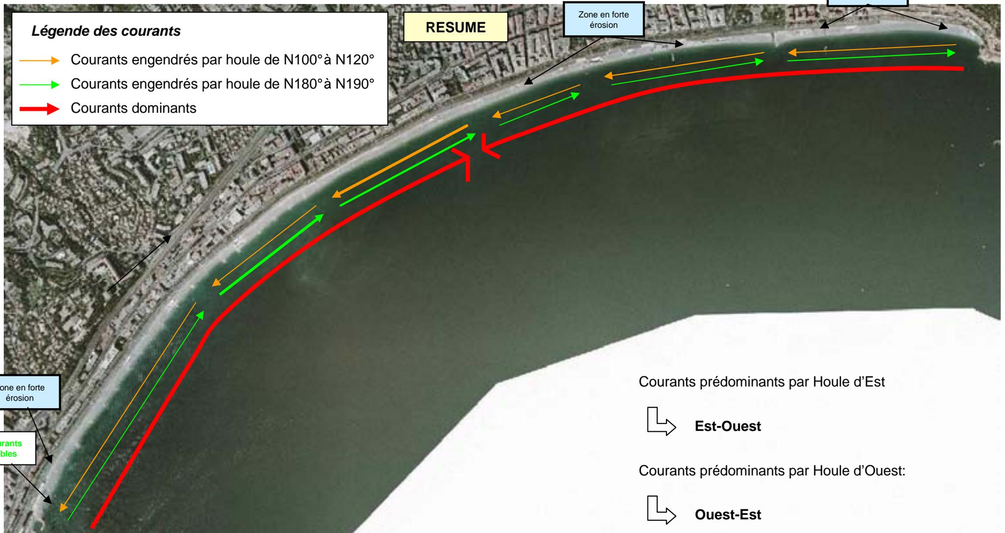
A cause de l'orientation « courbée » de la plage, et des structures diffractantes avoisinantes, le Cap de Nice à l'Est et l'Aéroport à l'Ouest, les courants dominants sont orientés Ouest-Est sur la partie Ouest de la plage et Est-Ouest sur la partie Est. Cependant, en fonction de l'orientation de la houle incidente, les courants peuvent à la fois être orientés Ouest-Est et Est-Ouest. Il n'y a donc pas de dérive sédimentaire parallèle à la plage dans une direction préférentielle donnée.
