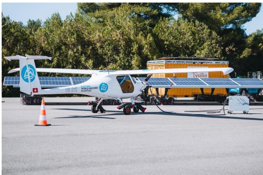
*La recharge en électricité des appareils se fera à l'énergie solaire*
