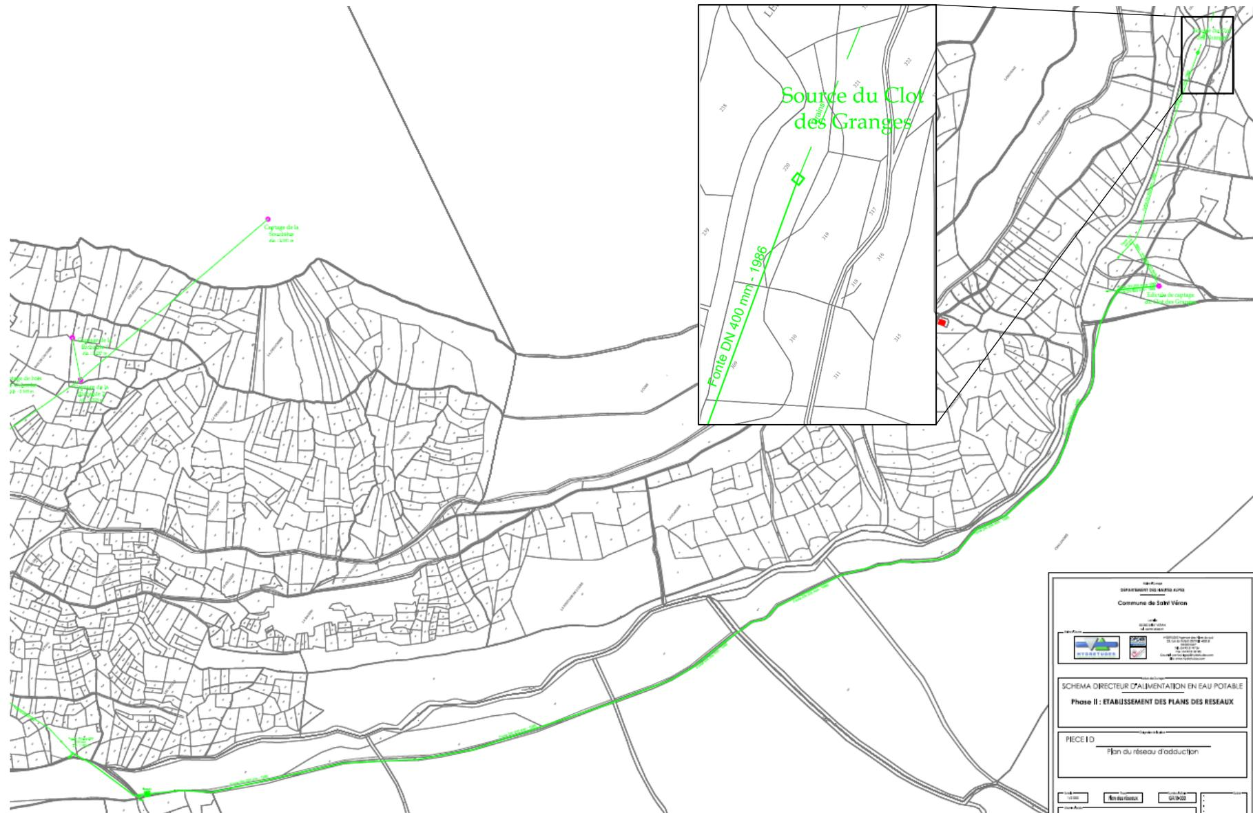
Figure 3 : Plan du réseau d'adduction d'eau potable de Saint Véra (HYDRETUDES, 2012)
