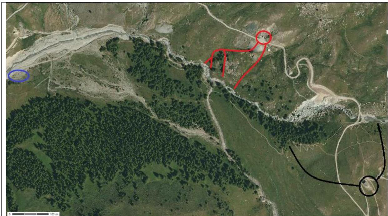
Position relative du champ captant Clos des Granges (en bleu), de la carrière (en rouge) avec le sens probable d'écoulement des eaux de parking, et de la chapelle (en noir) avec les sens possibles d'écoulement d'eau issue de cette dernière.
