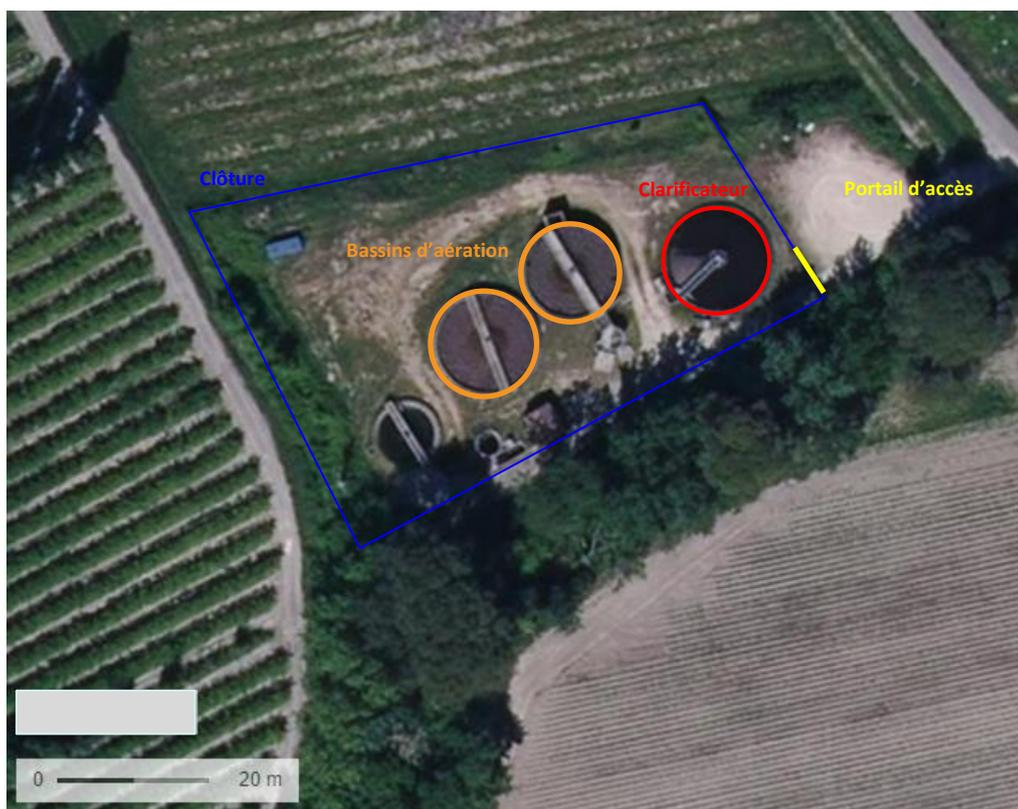
Figure 8 : Implantation des principaux ouvrages de la station de traitement des eaux usées actuelle de la commune de Saint-Andiol (Géoportail)
