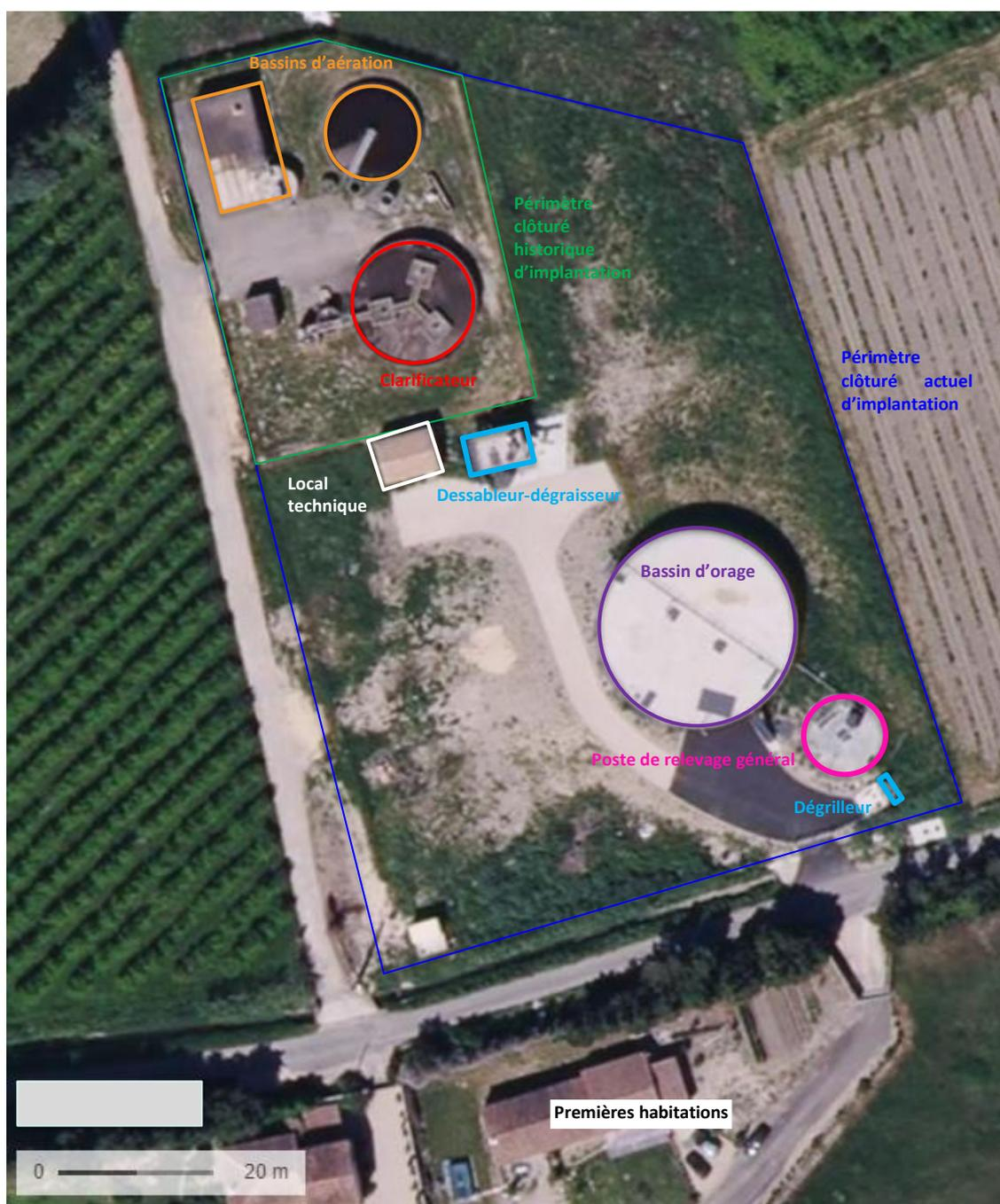
Figure 5 : Implantation des principaux ouvrages de la station de traitement des eaux usées actuelle de la commune de Cabannes (Géoportail)
