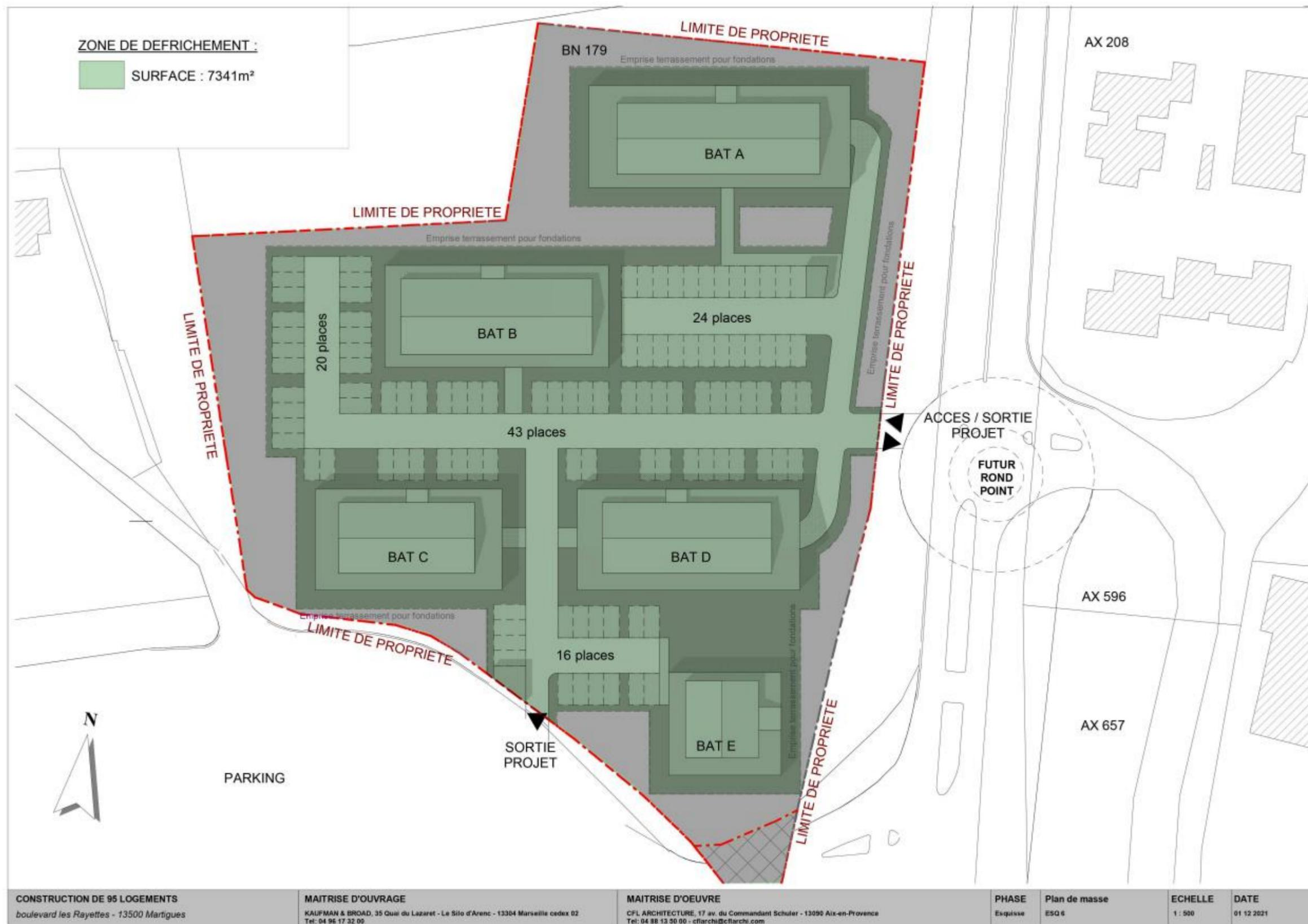
Figure 4 : Plan de masse avec surface de défrichement (Source : CFL ARCHITECTURE)
