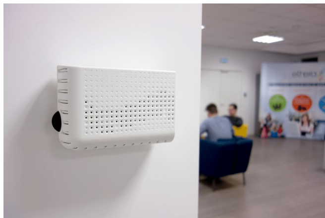
Exemple de station de mesures, type NEMO XT (ETHERA)
