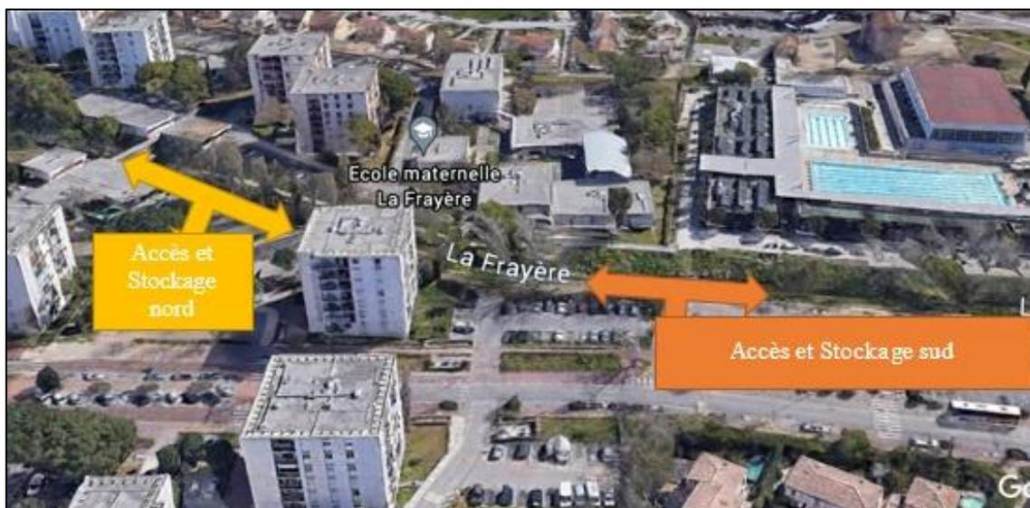
**Figure 7 : Accès et zones d'installation de chantier**
