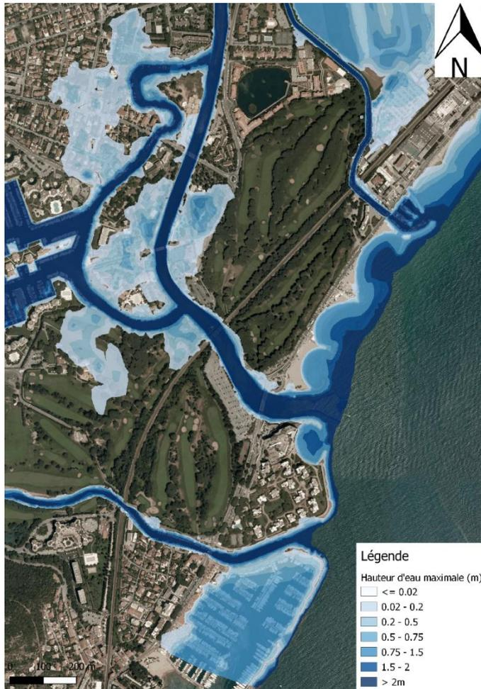
Figure 22 : Hauteur d'eau maximales pour Q100 après confortement
