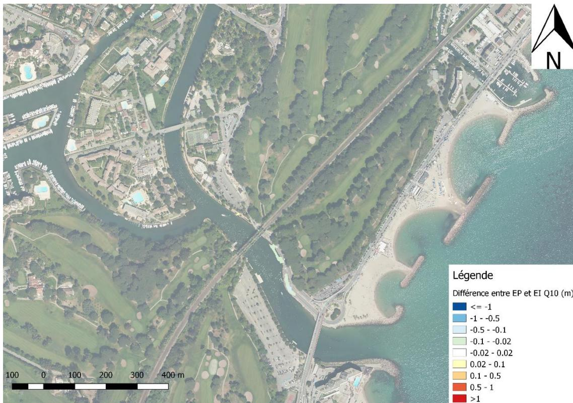
Figure 10 : Carte des différences de niveau d'eau entre l'état projet et l'état initial pour Q10
