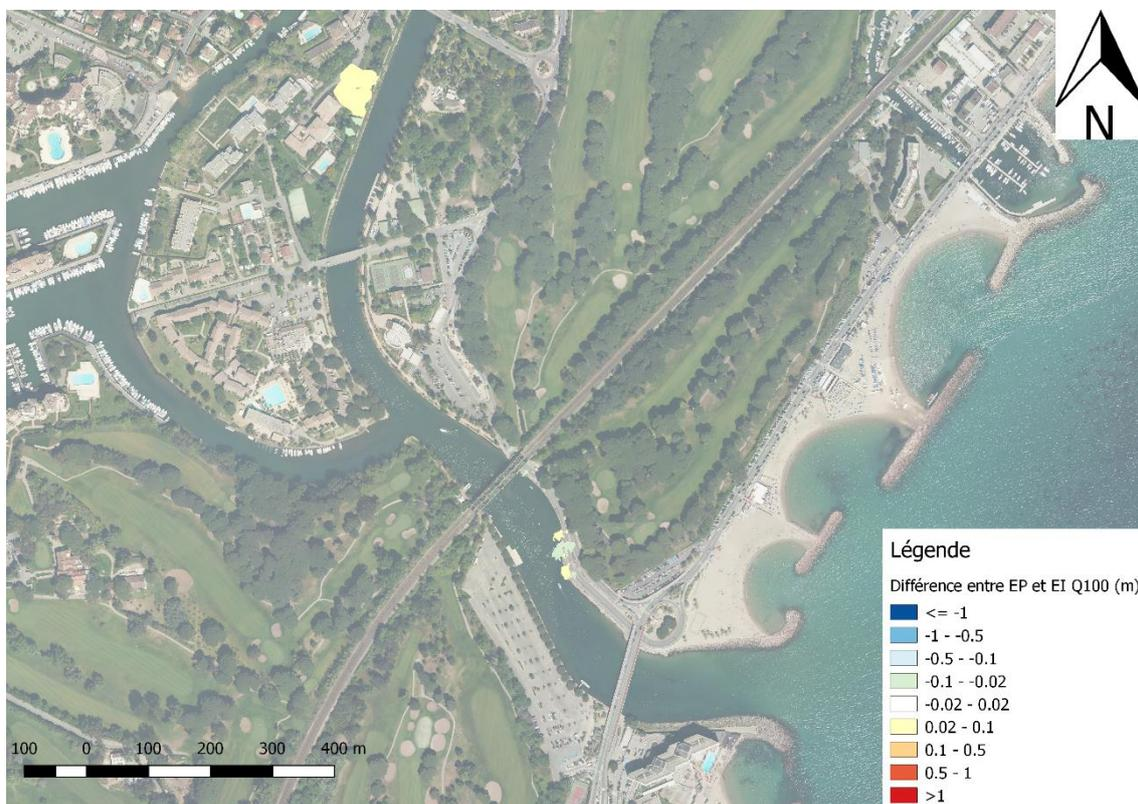
Figure 13 : Carte des différences de niveau d'eau entre l'état projet et l'état initial pour Q100
