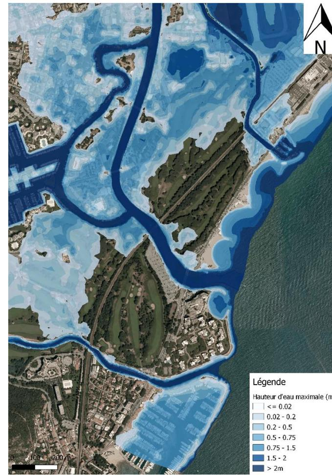
Figure 23 : Hauteur d'eau maximales pour Q1000 après confortement
