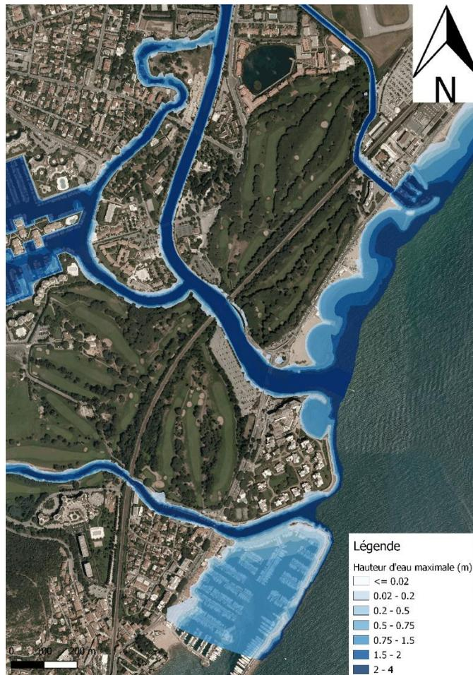
Figure 20 : Hauteurs d'eau maximales pour Q10 après confortement
