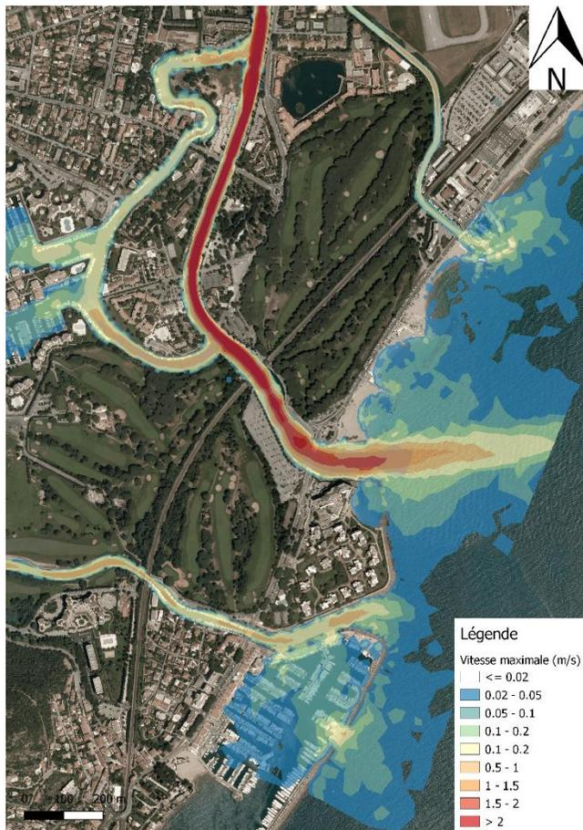
Figure 24 : Vitesses maximales pour Q10 après confortement
