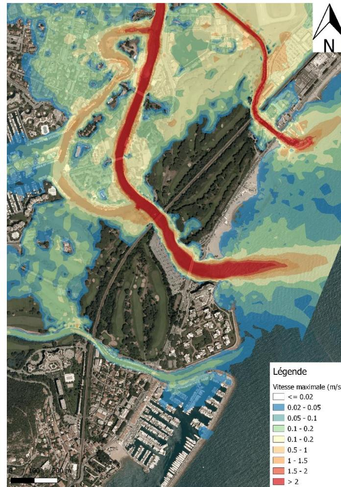
Figure 27 : Vitesses maximales pour Q1000 après confortement
