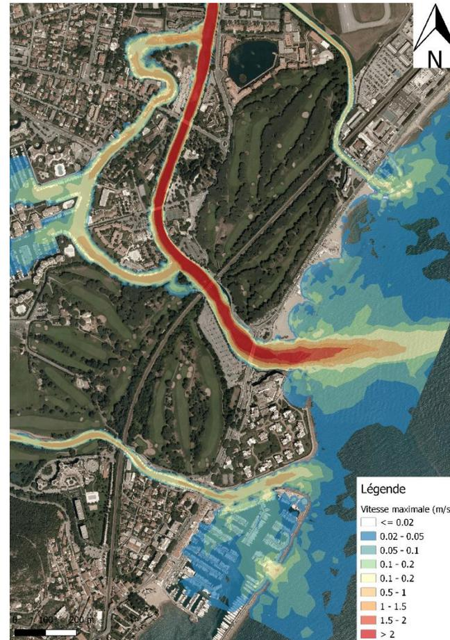
Figure 25 : Vitesses maximales pour Q30 après confortement
