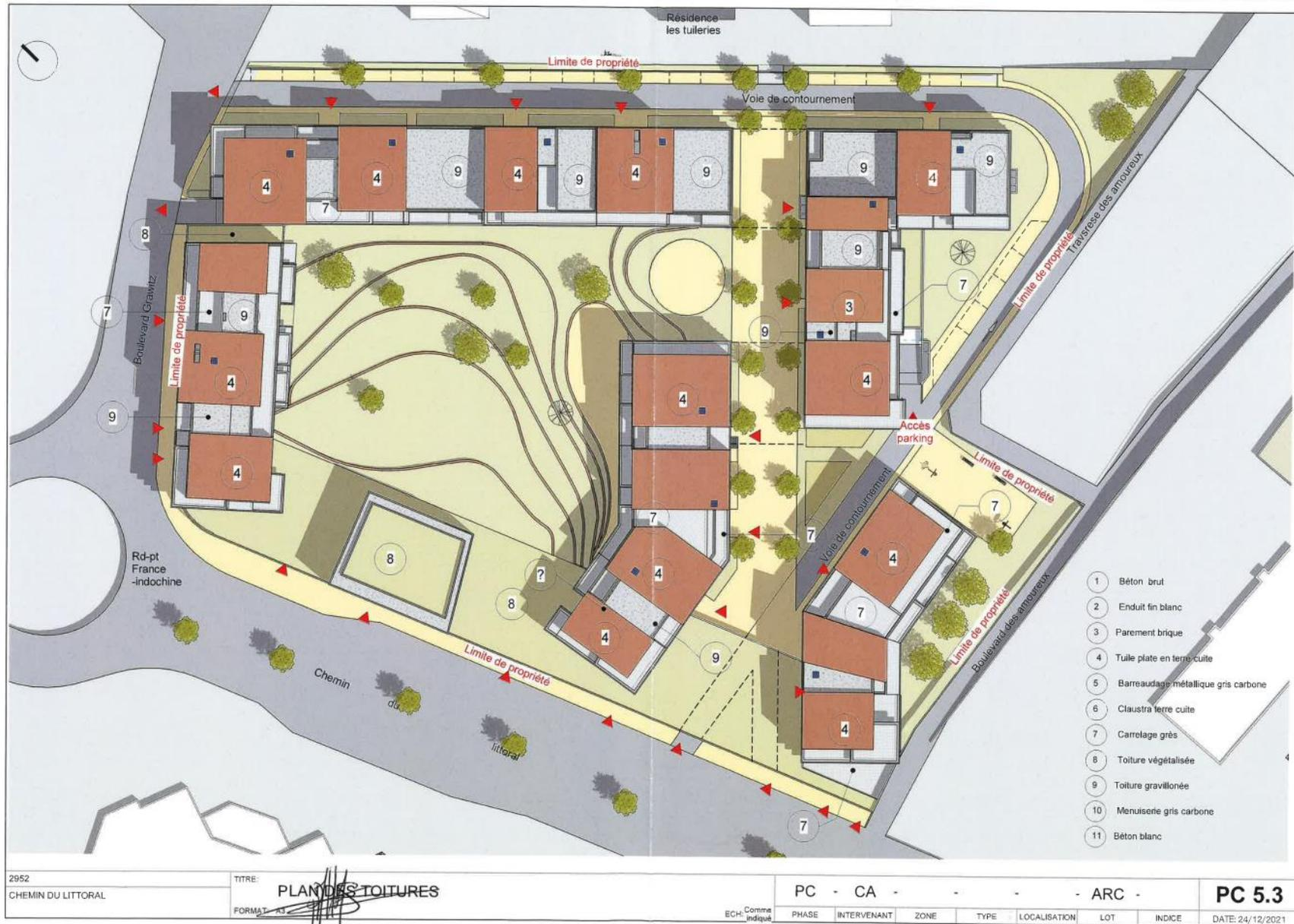
Figure 10. Plan des toitures (Source : Permis de construire)
