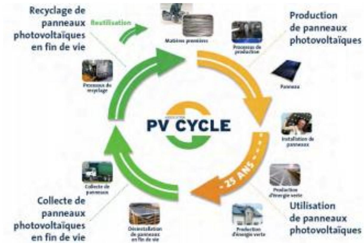
Figure 20. Cycle de vie des modules polycristallins (© PV CYCLE/SOREN)
