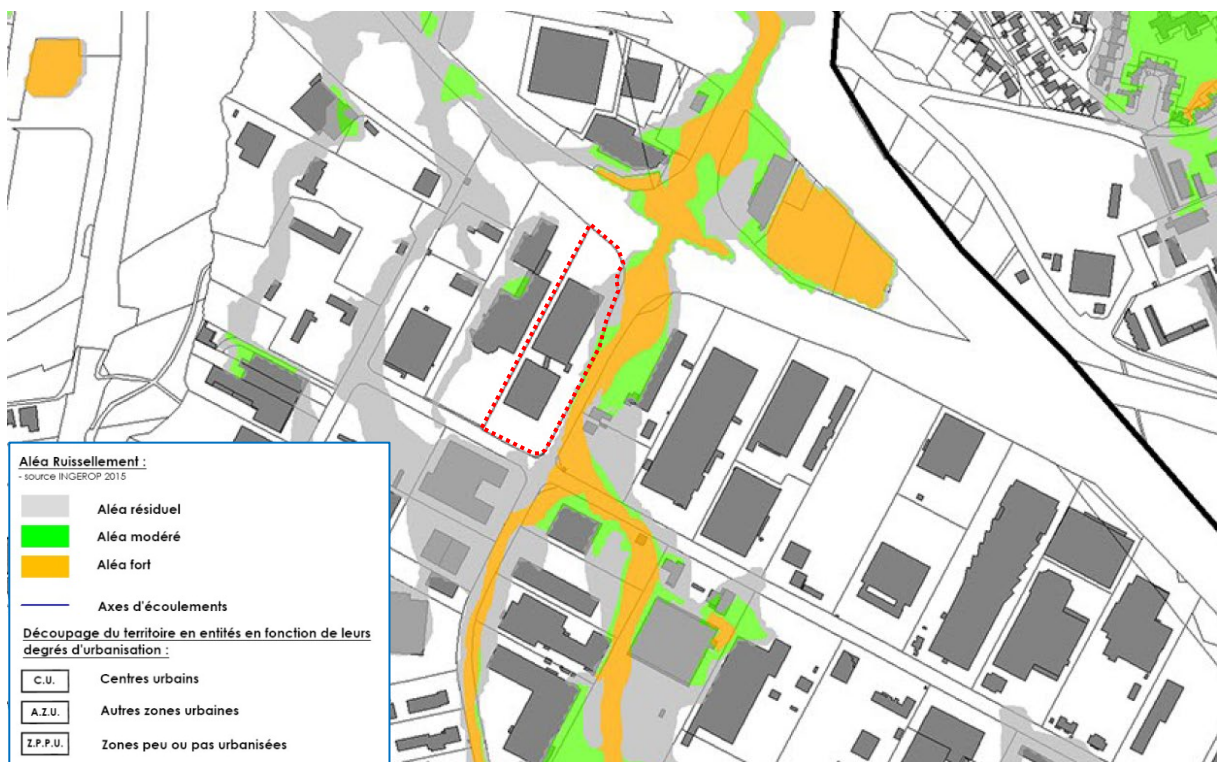
Extrait du plan des aléas inondation par débordement et ruissellement annexé au PLU
