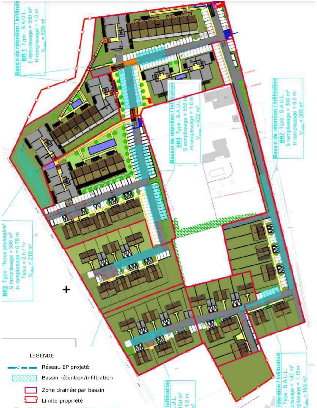
Figure 7 : Plan du dispositif de gestion des eaux pluviales
