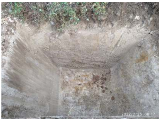
Sondage tractopelle n° 1 : Sol limono-argileux avec traits rédoxiques à moins de 25 cm de profondeur.
