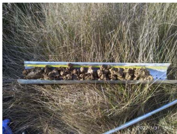
Sondage n° 11 : Sol limono-argileux avec traits rédoxiques dès 30 cm. Blocage à 80 cm de profondeur
