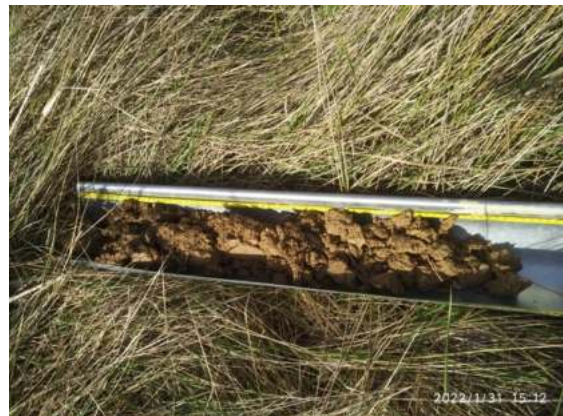
Sondage n° 10 : Sol limono-argileux avec traits rédoxiques dès 30 cm. Blocage à 70 cm de profondeur
