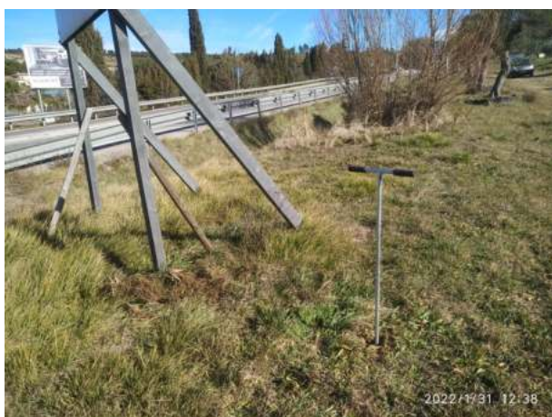
Sondage n° 2 : Sondage bloqué à 40 cm de profondeur.
