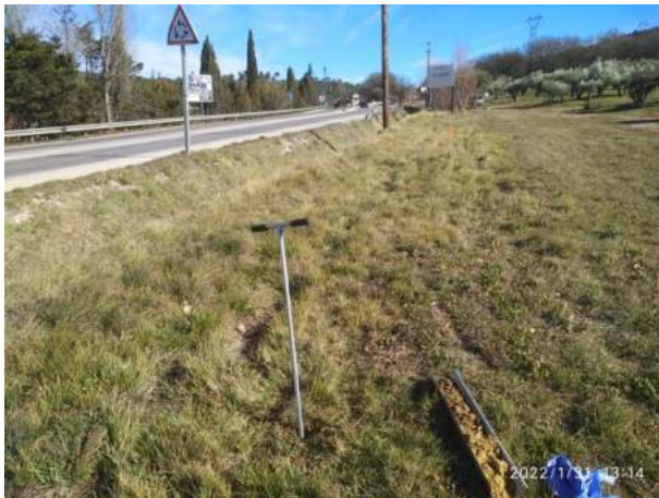
Sondage n° 5 : Sol limono-argileux puis sableux à 60 cm de profondeur.
