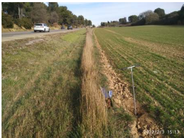
Sondage n° 13 : Sondage bloqué à 30 cm de profondeur
