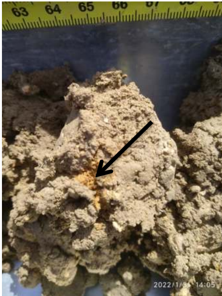
Sondage n° 8 : Sol limoneux puis limono-argileux avec trace d’hydromorphie (flèche).
