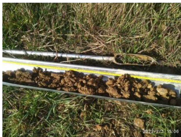
Sondage n° 12 : Sol limono-argileux sans traits d'hydromorphie. Blocage à 90 cm de profondeur
