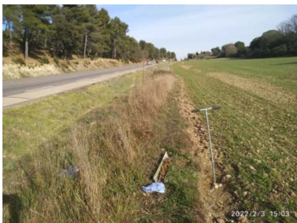
Sondage n° 12 : Sol limono-argileux sans traits d'hydromorphie. Blocage à 90 cm de profondeur
