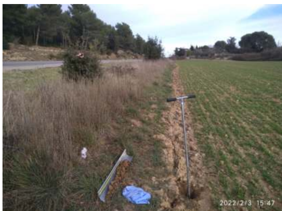
Sondage n° 16 : Sol limono-argileux avec traits rédoxiques de 30 à 70 cm ne s'intensifiant pas. Blocage à 90 cm de profondeur
