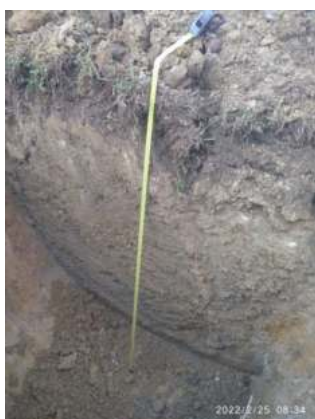
Sondage tractopelle n° 2 : Sol limono-argileux avec traits rédoxiques s'intensifiant en profondeur.
