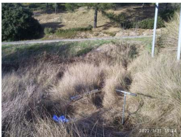
Sondage n° 11 : Sol limono-argileux avec traits rédoxiques dès 30 cm. Blocage à 80 cm de profondeur
