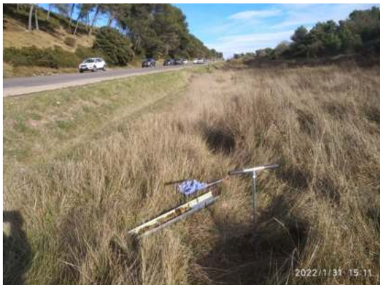
Sondage n° 10 : Sol limono-argileux avec traits rédoxiques dès 30 cm. Blocage à 70 cm de profondeur
