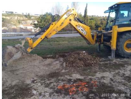
Sondage tractopelle n° 1 : Sol limono-argileux avec traits rédoxiques à moins de 25 cm de profondeur.
