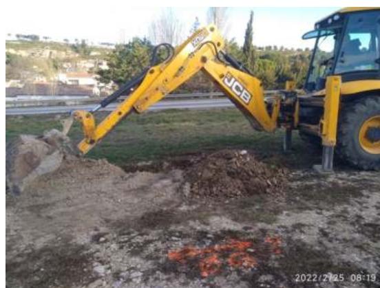
Sondage tractopelle n° 2 : Sol limono-argileux avec traits rédoxiques s'intensifiant en profondeur.
