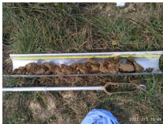
Sondage n° 16 : Sol limono-argileux avec traits rédoxiques de 30 à 70 cm ne s'intensifiant pas. Blocage à 90 cm de profondeur
