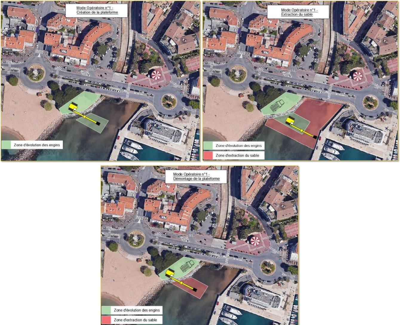
*Schémas de principe par dragage à la pelle - accès par la plage (CMME, 2022)*
