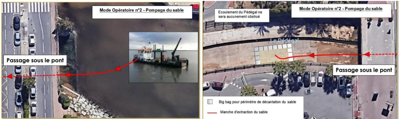
*Schémas de principe par dragage hydraulique depuis une barge (CMME, 2022)*
