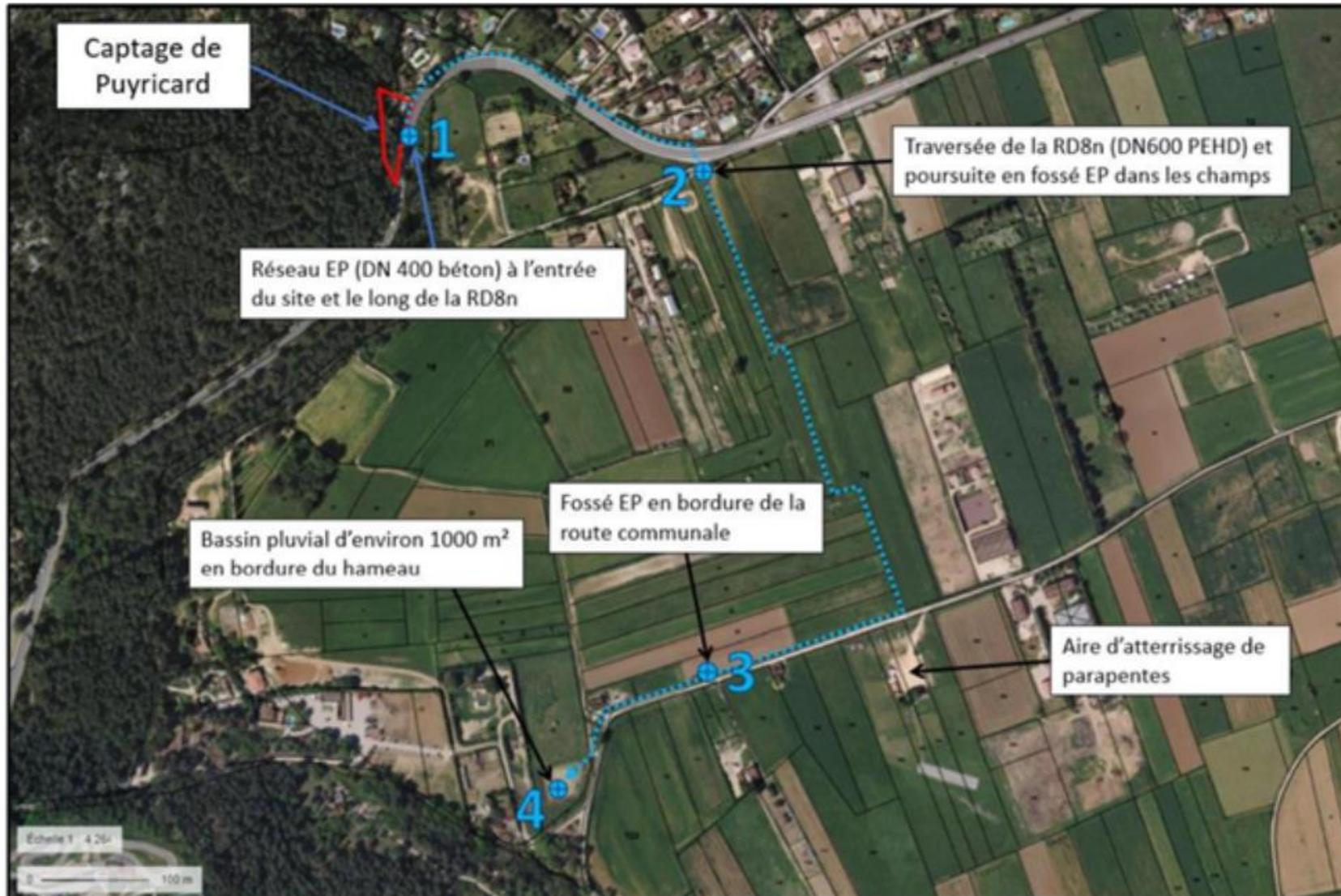
Schéma de circulation du réseau d'eau pluviale (infiltration de l'eau d'exhaure décantée dans les embuts)
