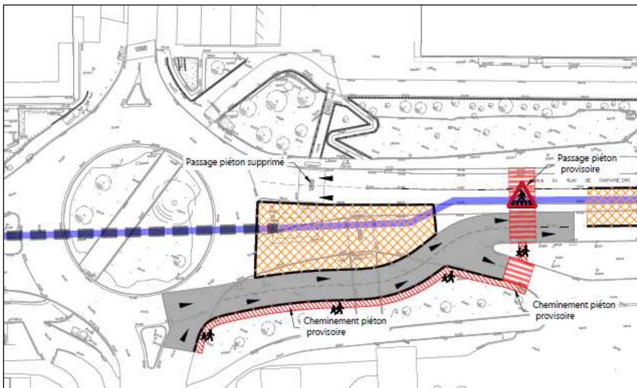
Figure 42. Dévoiement de la circulation au droit des zones travaux des microtunneliers
