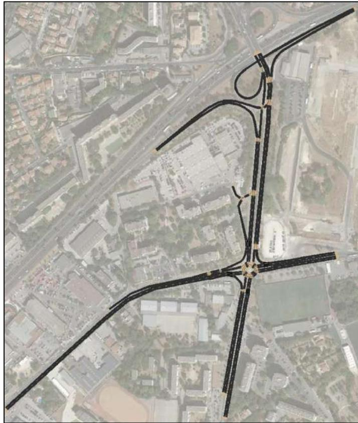
Figure 3 : Réseau original modélisé sous Transmodeler
