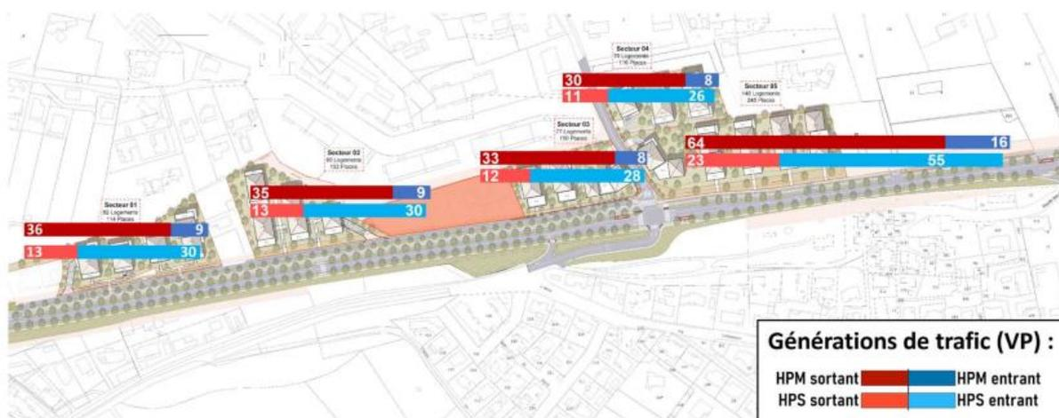
Parmi les scénarios proposés, un fonctionnement qui tient compte du raccordement de la contre-allée existante sur le BUM, en amont du carrefour est étudié. Ce fonctionnement considère les flux sortants des secteurs 01 et 02. L'analyse de cette hypothèse repose sur la méthode dite « créneau critique », détaillée par le CEREMA, afin de calculer les temps d'attente moyens. Des temps d'attente inférieurs à 30 secondes traduisent un fonctionnement acceptable.
