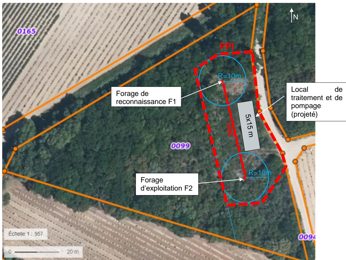
Figure 12 : Délimitation du périmètre de protection immédiate
