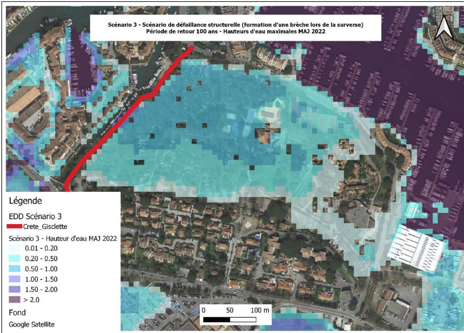
Figure 23 - Scénario de défaillance structurelle – Niveau des plus hautes eaux – Mise à jour 2022
