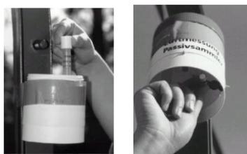
Figure 2 : Illustration de l'installation des tubes passifs - NO<sub>2</sub>
