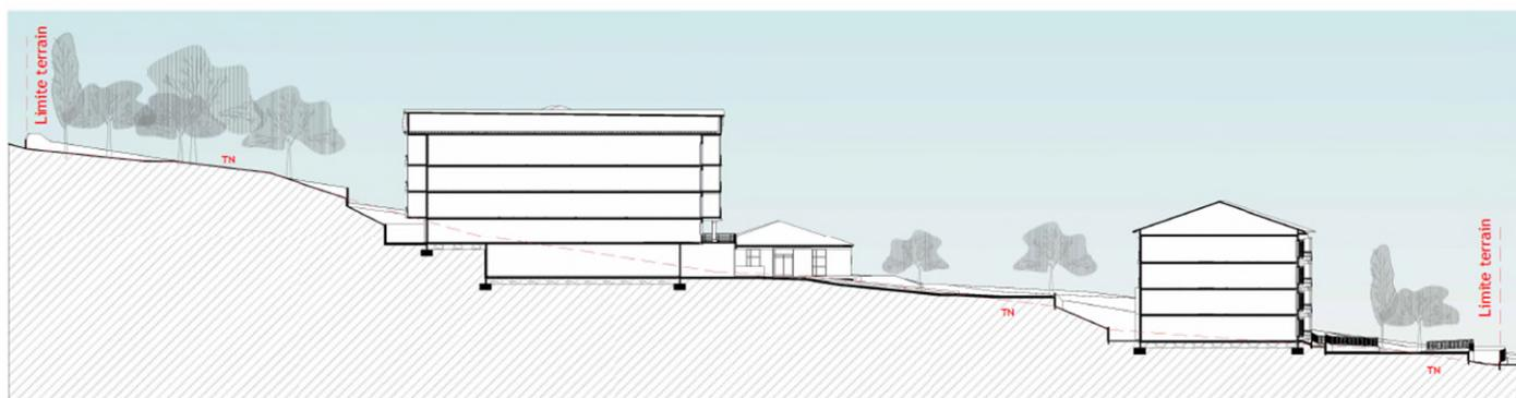
Figure 15 : Vue transverse de l'implantation des bâtiments respectant la topographie du milieu. La ligne rouge pointillé correspond à la topographie actuelle du terrain, qui ne sera que légèrement modifiée par l'implantation des futurs bâtiments. (Source : Document Ateliers Rossello Architectes)
