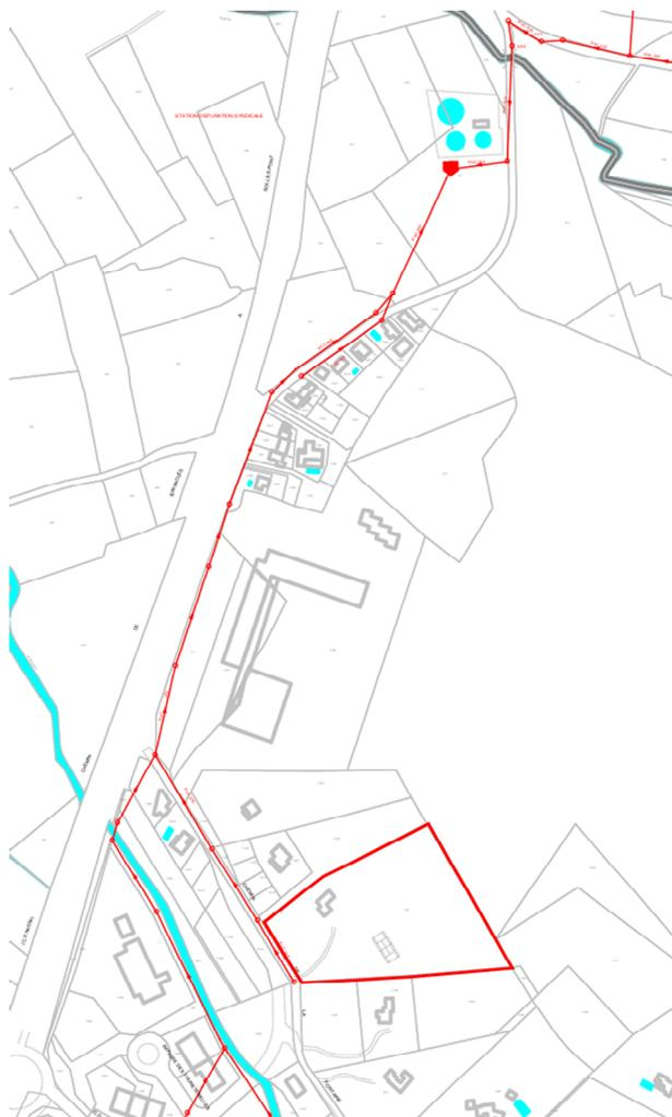
Figure 5 : Localisation des réseaux Alimentation en Eau Potable (bleu) et Eaux Usées (rouge) au droit du projet (source : Suez Environnement)
