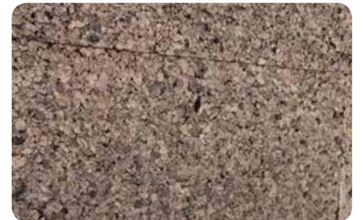
Les façades intérieures du bâtiment seront revêtues de liège. Ce matériau a l'avantage de rester dans les tons repérés dans l'environnement et choisis pour ce projet. Son caractère isolant lui confère un avantage climatique, sa fabrication et sa mise en œuvre respectent les meilleurs critères écologiques, sa capacité d'absorption phonique participera au calme du lieu.
