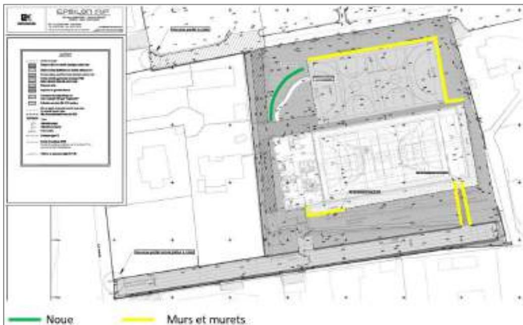
Localisation de principe murs et murets et noue - Fond Extrait du plan de principe VRD Voiries – Bordures – Epsilon GE 13/02/2023
