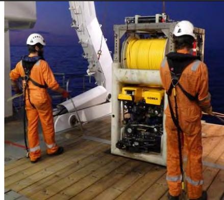
Figure 35 - Mise à l'eau en sécurité avec le portique arrière (source : SAAS)
