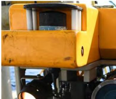
Figure 15 - Sonar installé sur le ROV (source : SAAS)
