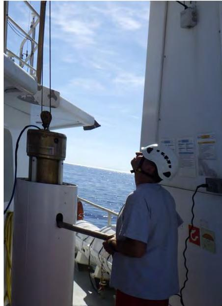
Figure 44 - Mise en œuvre de la perche USBL (source : SAAS)
