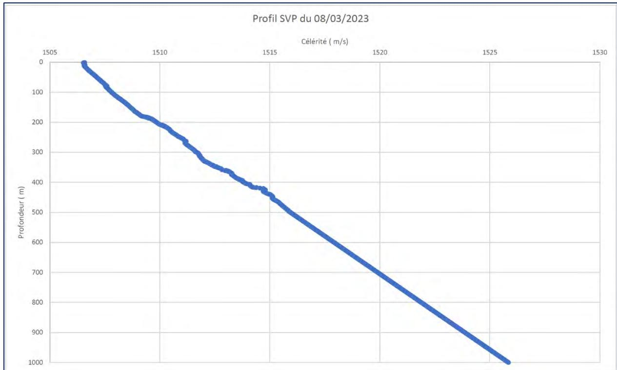
Figure 62 - Profil SVP du 08 mars 2023 réalisés au début du survey. (Source : SAAS)
