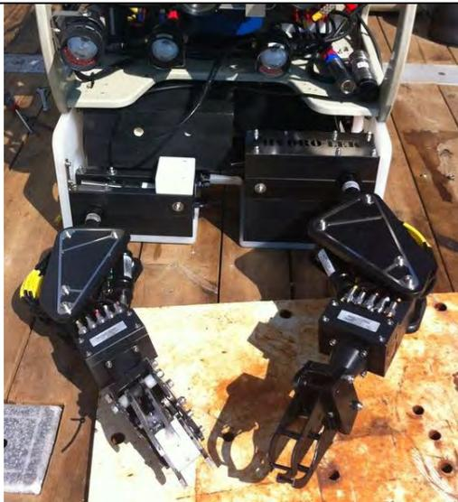
Figure 24 - Skid ROV APACHE SAAS 2500m avec 2 bras
