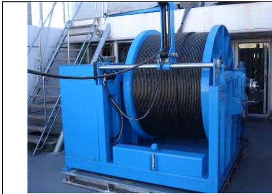
Figure 32 - Treuil électro-porteur ROV DT MARINE (source : SAAS)
