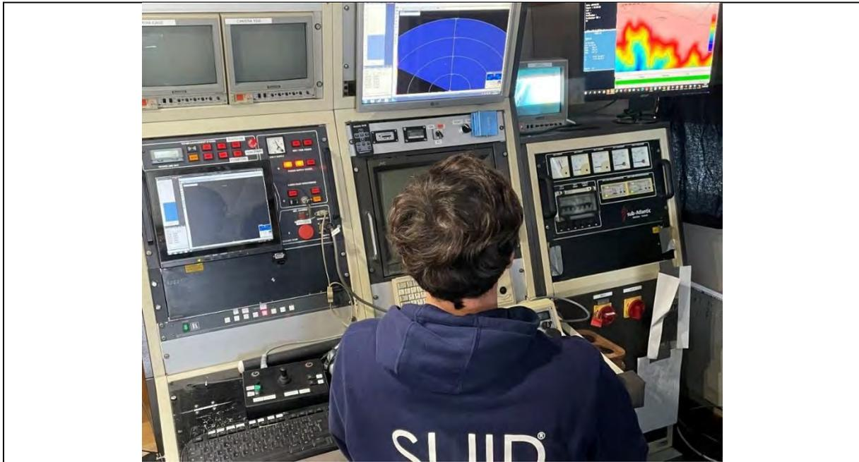
Figure 36 - Pupitre de commande du ROV APACHE 2500m SAAS (source : SAAS)
