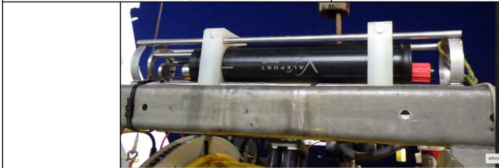
Figure 45 - Profileur SVP sur cage ROV (source : SAAS)
