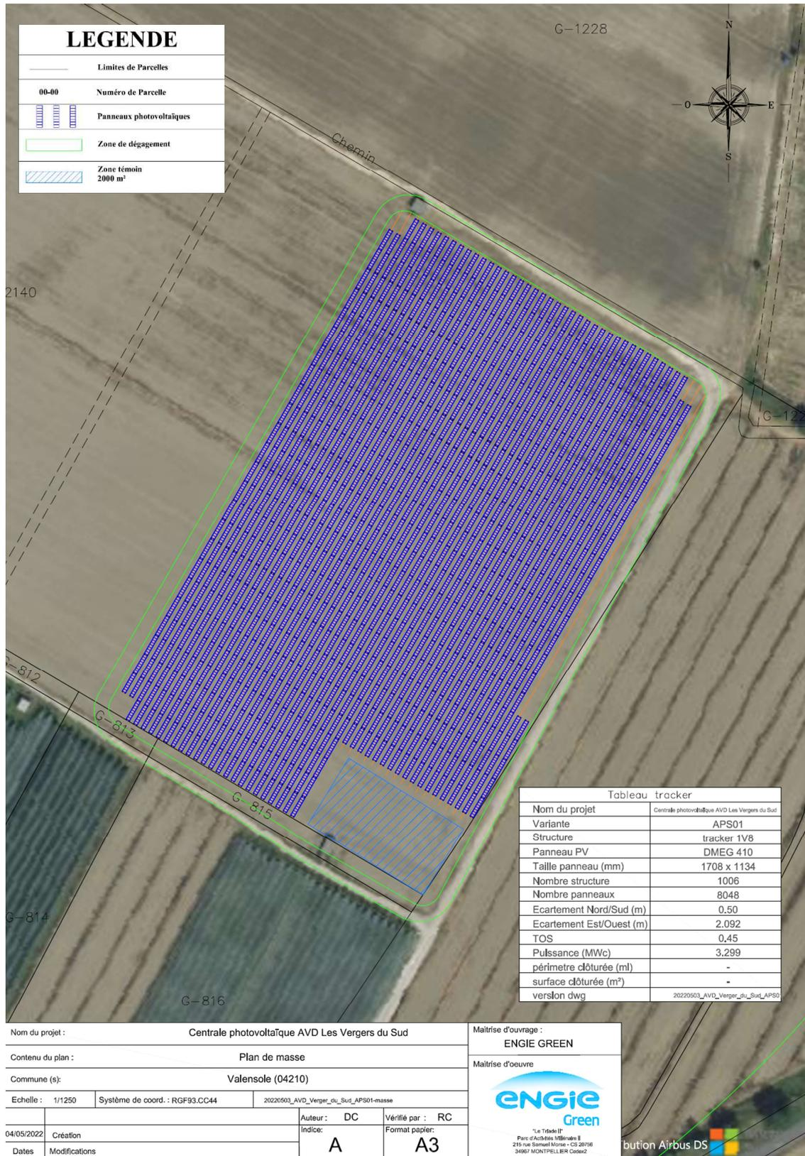
Figure 2. Plan d'implantation et données techniques du projet agrivoltaïque (© Engie Green, 2022)
