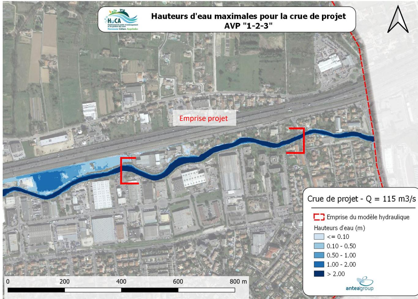
Figure 45 : Hauteurs d'eau maximales théoriques calculées pour la crue de projet en état projet – Source : AVP
