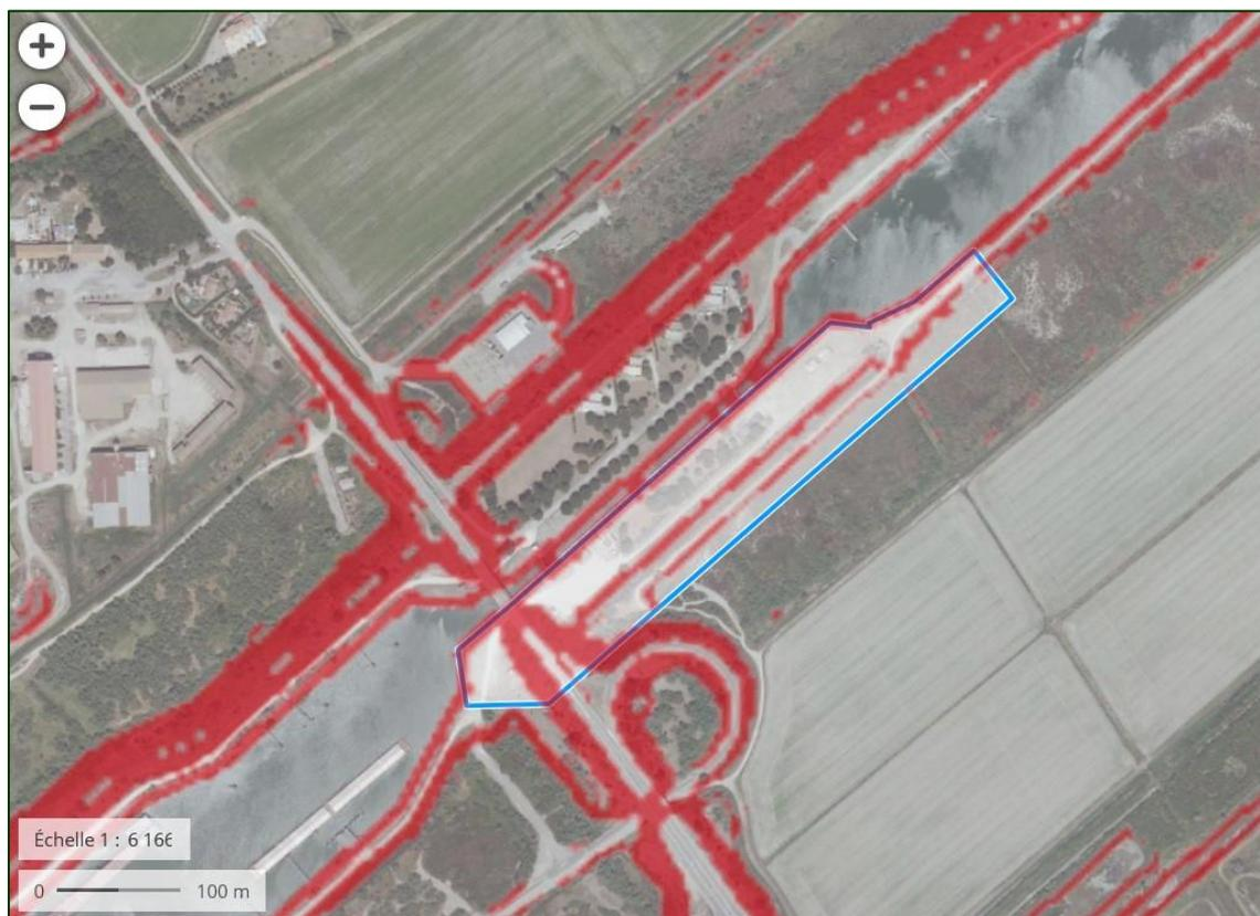
Figure 3 : Données sur la topographie du site, en zone rouge clair les secteurs de pente supérieure à 10% selon BCAE (source : Géoportail).
